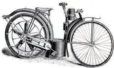
Il motociclo realizzato da Felix Millet nel 1892, dotato di un motore radiale rotativo direttamente connesso alla ruota posteriore.
