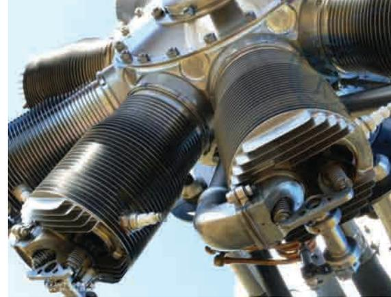
Primo piano sui cilindri dell'UR.2, da cui si nota la testa finemente lavorata e la candela laterale, caratteristica dello schema Le Rhône
