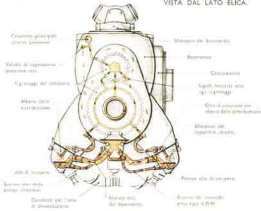
Fig. 2 Circuito di lubrificazione
